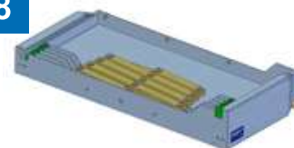
Kryt s nůžkovým mecha- nismem / Cover with scissor mecha- nism / Abdeckung mit einem Scherenmechanismus
